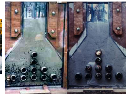
パイプレーターの役割:突き棒
